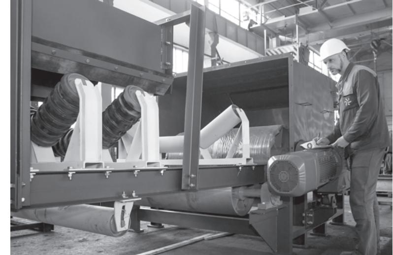
конвейер с 2-мя концевыми приводными барабанами и 6-ю местами загрузки для транспортируемого материала, — говорит Дмитрий Калужский. — Его «брать» К7 — нереверсивный конвейер длиной 75 метров с максимально допустимым углом подъема ленты 180. А К8-17-метровый нереверсивный «коротыш».
